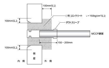
ダクトスリーブへの鋼管差し込み長は、150mm ~ 200mm 程度確保して下さい。 尚、詳細は製造メーカーにお問い合わせ下さい。
