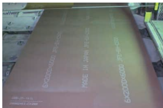
プライマー処理された標準エバーハード厚鋼板（EVERHARD-C500（JFE-EH-C500））の典型的な外観例
